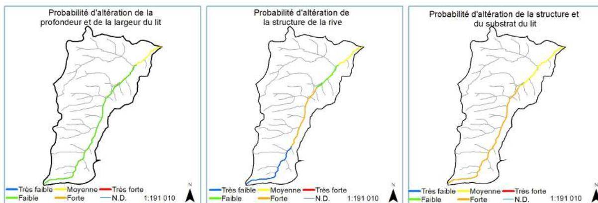
La forte probabilité d'altération de la morphologie est principalement en lien avec la probabilité d'altération de la structure du lit mineur. La structure des rives présente des altérations variables : les tronçons médians et aval étant plus altérés. Enfin, la probabilité d'altération de la profondeur et largeur du lit est moyenne sur le dernier tronçon du cours d'eau.
