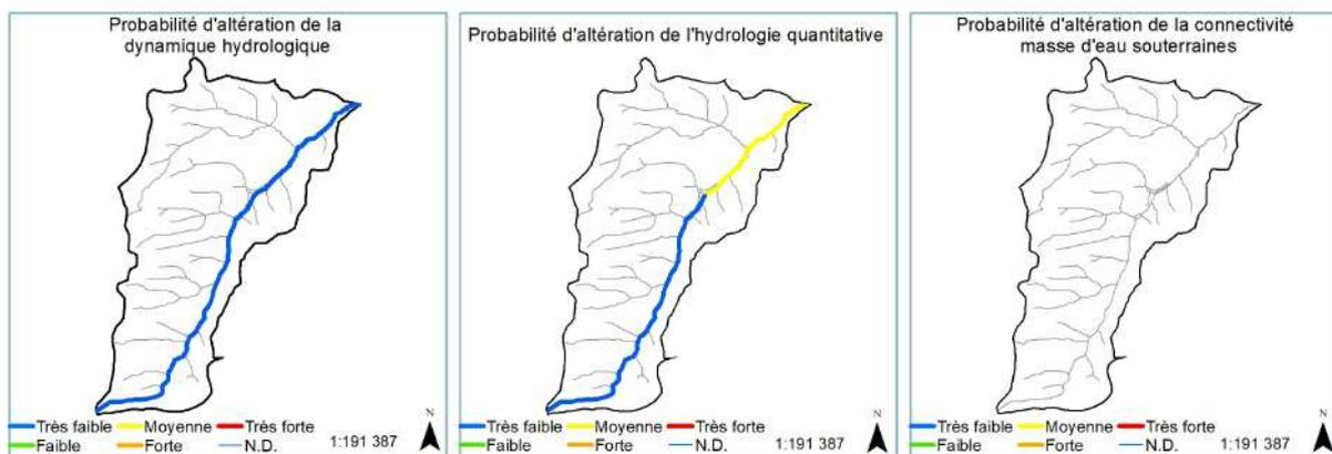
Le compartiment hydrologie est celui présente un faible potentiel d'altération. En effet seule la probabilité d'altération de l'hydrologie quantitative est jugée moyenne sur les tronçons aval.
