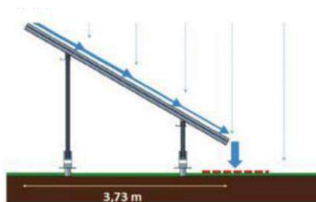
Illustration 2 : zone à risque de formation de rigoles d'érosion en contrebas des panneaux
