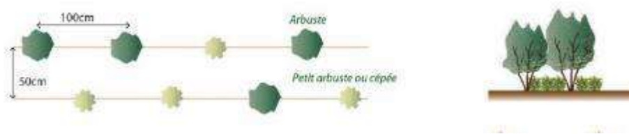
Figure 57: Principe d'implantation d'une haie champêtre
