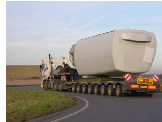
Transport de la nacelle
