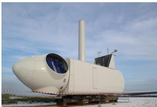
La nacelle d'une éolienne, attendant d'être fixée au sommet du mât, en arrière plan. ©RLP.
